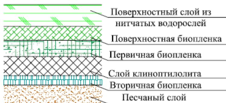
Рис. 2.2. Фильтрующая пленка фильтра с клиноптилолитовым слоем
