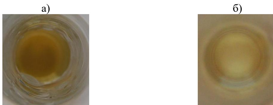
**Рис. 2.12. Цветность исходной (а) и очищенной (б) воды при использовании технологии биосорбции**
