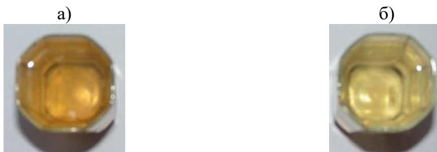
Рис. 2.7. Цветность исходной (а) и очищенной (б) воды при использовании технологии медленного фильтрования
