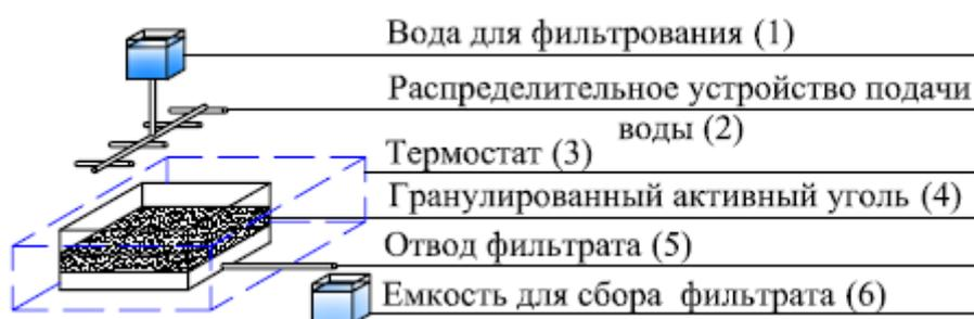
Рис. 2.8. Экспериментальная установка для изучения биосорбционных процессов
