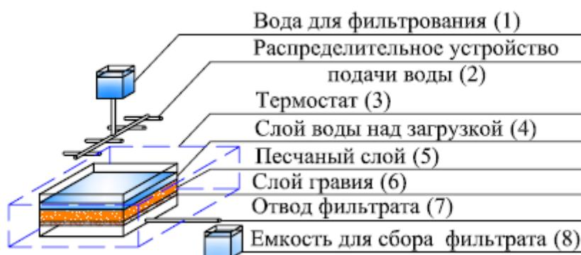
Рис. 2.4. Конструкция медленного фильтра, используемого для постановочных экспериментов
